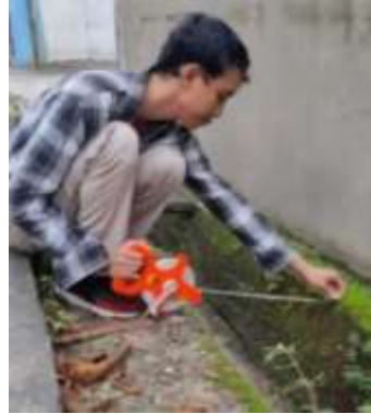
Gambar 4 Pengukuran Dimensi Drainase
