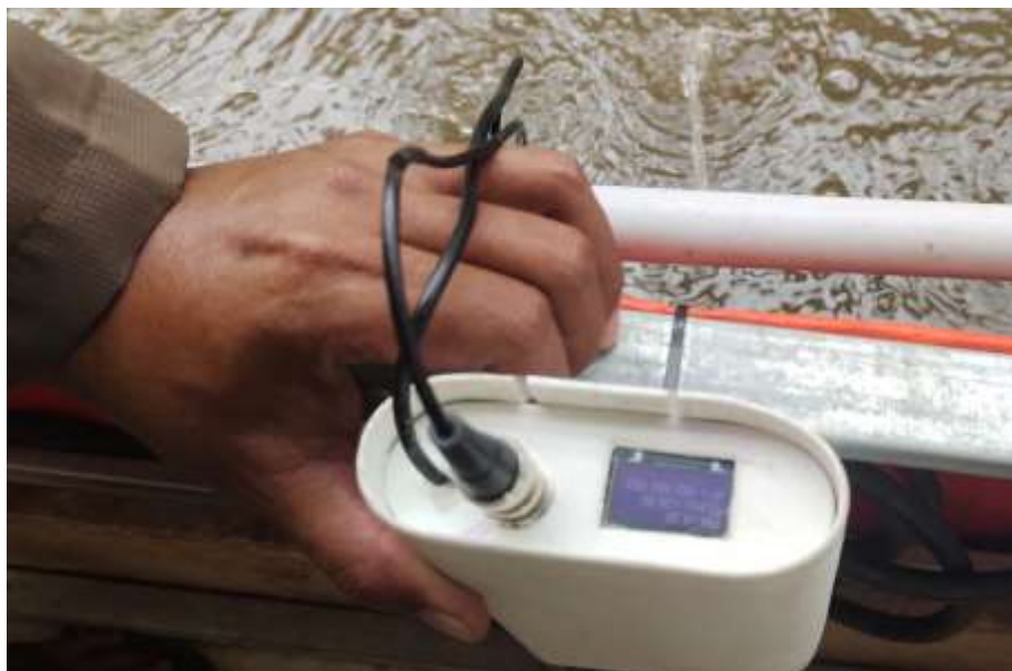
Gambar 8. Pemasangan alat pengukur pH dan suhu keramba
