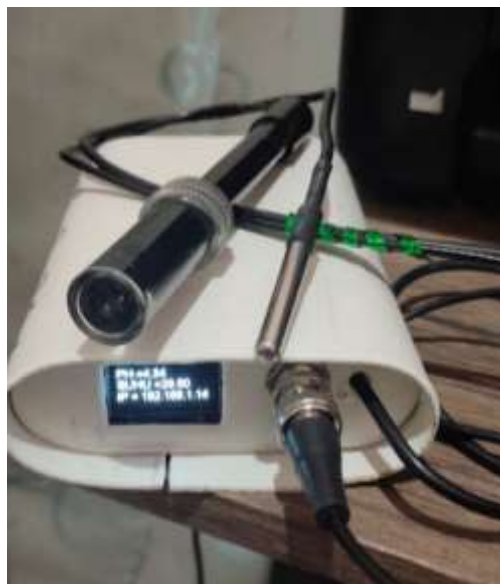
Gambar 6, alat monitoring pH dan Suhu berbasis IoT
